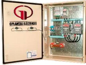
El tablero de transferencia automático modelo PE-1000 (220V) está formado por contactores magnéticos con opción en transferencia a doble tiro, y este, tiene la función de hacer la transferencia y retransferencia de la carga de la red de CFE a la planta y viceversa por medio del módulo de control DSE-4520 o DSE 7320. Todo esto de forma automática o manual.
