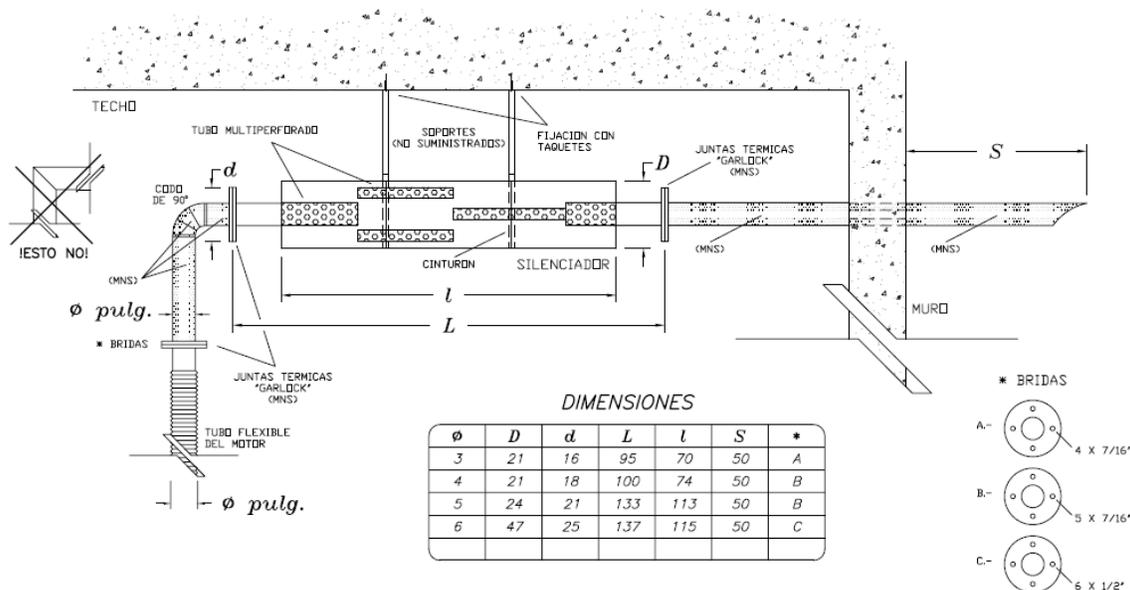
1. Se recomienda fijar al techo los taquetes de expansión y soportes de solera (no usar taquetes de madera)
