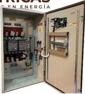
El tablero de transferencia automático modelo PE-300 (220V) está formado por contactores magnéticos con opción en transferencia a doble tiro, y este, tiene la función de hacer la transferencia y retransferencia de la carga de la red de CFE a la planta y viceversa por medio del módulo de control DSE-4520 o DSE 7320. Todo esto de forma automática o manual.
