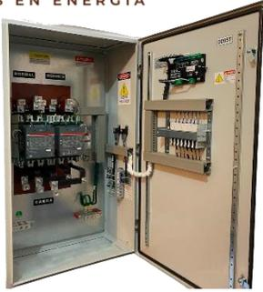
El tablero de transferencia automático modelo PE-500 (220V) está formado por contactores magnéticos con opción en transferencia a doble tiro, y este, tiene la función de hacer la transferencia y retransferencia de la carga de la red de CFE a la planta y viceversa por medio del módulo de control DSE-4520 o DSE 7320. Todo esto de forma automática o manual.
