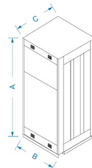
Está diseñada con el fin de evitar obras civiles lo que implica ahorro de espacio, instalación en cualquier lugar, ofreciendo una protección total que le permite soportar las inclemencias del clima con un recubrimiento interno de espuma.
