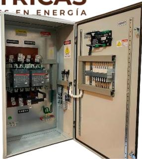
El tablero de transferencia automático modelo PE-800 (220V) está formado por contactores magnéticos con opción en transferencia a doble tiro, y este, tiene la función de hacer la transferencia y retransferencia de la carga de la red de CFE a la planta y viceversa por medio del módulo de control DSE-4520 o DSE 7320. Todo esto de forma automática o manual.
