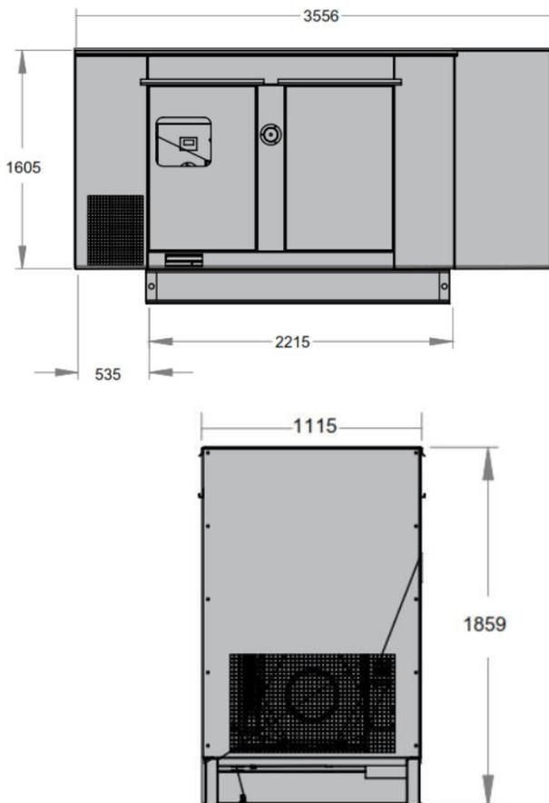
Está diseñada con el fin de evitar obras civiles lo que implica ahorro de espacio, instalación en cualquier lugar, ofreciendo una protección total que le permite soportar las inclemencias del clima con un recubrimiento interno de espuma.
