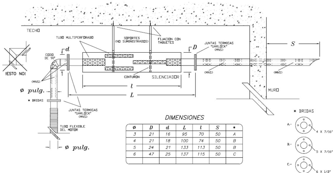
1. Se recomienda fijar al techo los taqueteros de expansión y soportes de solera (no usar taqueteros de madera)
