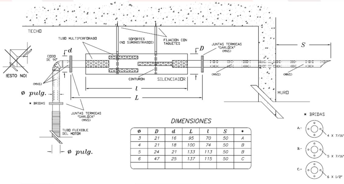
1. Se recomienda fijar al techo los taquetes de expansión y soportes de solera (no usar taquetes de madera)
