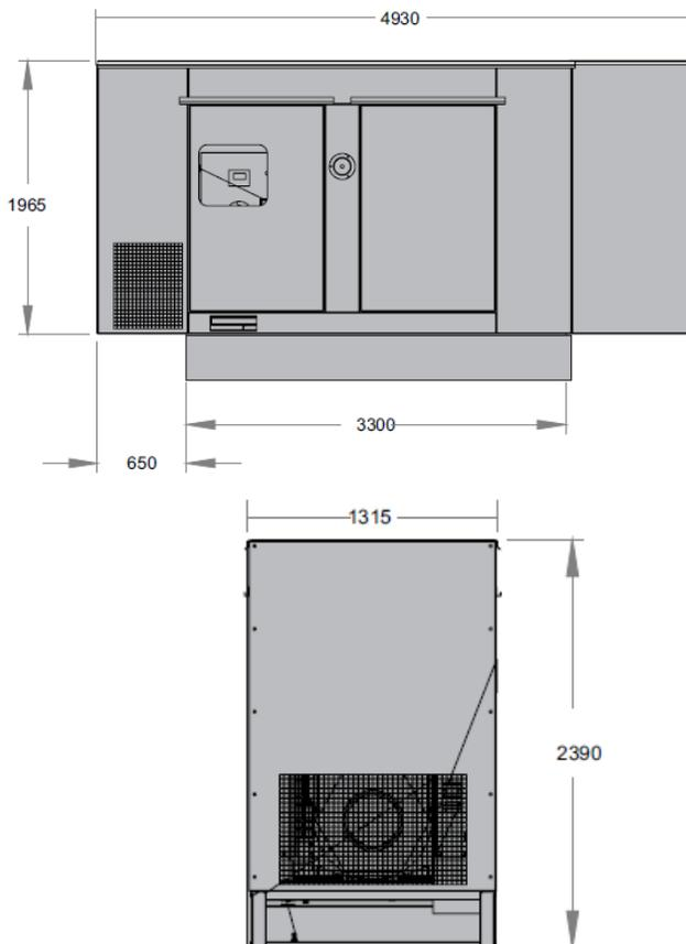
Está diseñada con el fin de evitar obras civiles lo que implica ahorro de espacio, instalación en cualquier lugar, ofreciendo una protección total que le permite soportar las inclemencias del clima con un recubrimiento interno de espuma.
