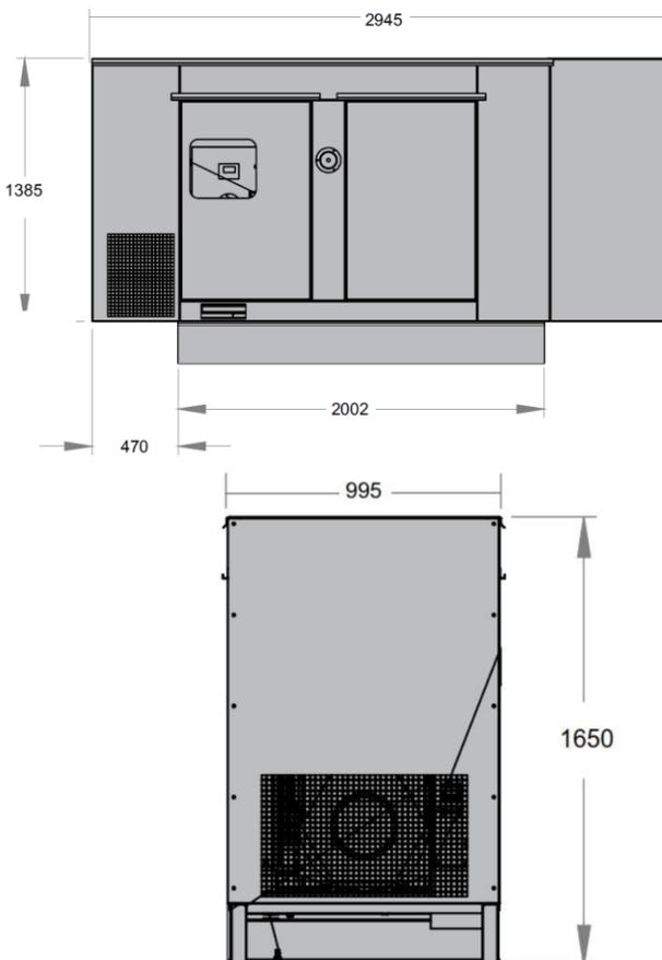
Está diseñada con el fin de evitar obras civiles lo que implica ahorro de espacio, instalación en cualquier lugar, ofreciendo una protección total que le permite soportar las inclemencias del clima con un recubrimiento interno de espuma.
